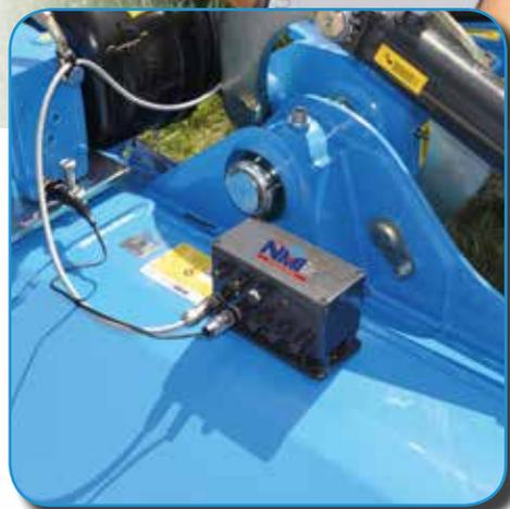
NMI (Nobili Mulching Interface, premiata come Segnalazione Tecnica EIMA 2018) è un sistema elettronico brevettato in grado di rilevare le condizioni di funzionamento anomale della trincia NOBILI. E' interfacciabile ad un qualsiasi dispositivo iOS/Android attraverso connessione Bluetooth scaricando l'apposita app dagli store ufficiali.
