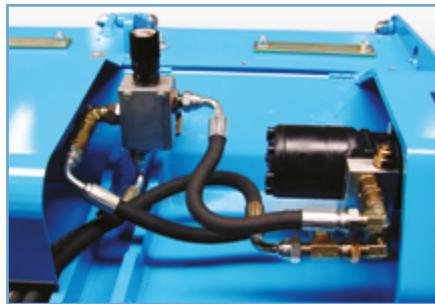
**Trasmissione idraulica del pick-up con valvola di regolazione di velocità e possibilità di invertire il moto.**
