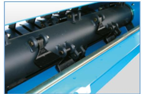
**Rotore di grosse dimensioni con 8 file di mazze per la triturazione dei sarmenti fino a 10 cm di diametro. Controcoltelli lisci smontabili**
