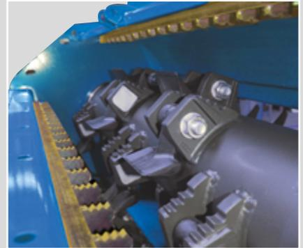
Rotore con supporti dentati con 3 controcoltelli dentati
