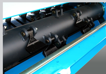
Rotore di grosse dimensioni con 8 file di mazze per la triturazione dei sarmenti fino a 10 cm di diametro. Controcuchilli lisci smontabili Large dimensions rotor with 8-hammer rows for mulching branches up to 10 cm in diameter. Removable straight counter-knives Rotor de gran tamaño con 8 filas de martillos cuchara para la trituración de restos hasta 10 cm de diámetro. Contra-cuchillas rectas desmontables
