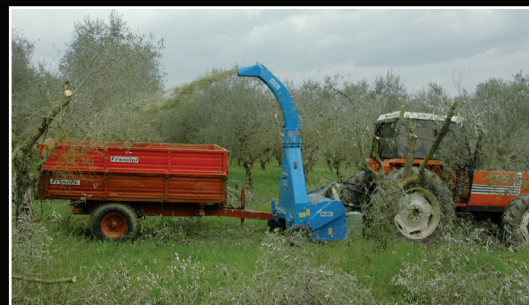
TRP-CV Regolazione idraulica del flusso dei sarmenti triturati TRP-CV Hydraulic adjustment of mulched pruning flow rate TRP-CV Regulación hidráulica del flujo de poda triturada
