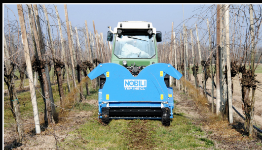
TRP-CL Regolazione meccanica o idraulica del flusso dei sarmenti triturati TRP-CL Mechanical or hydraulic adjustment of mulched pruning flow rate TRP-CL Regulación mecánica o hidráulica del flujo de poda triturada
