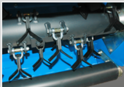
Coltello mobile per erba Swinging knife for grass Cuchilla móvil para hierba
