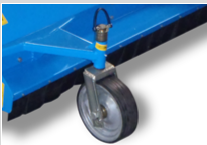
Ruote pivotanti anteriori Front pivoting wheels Ruedas delanteras pivotantes
