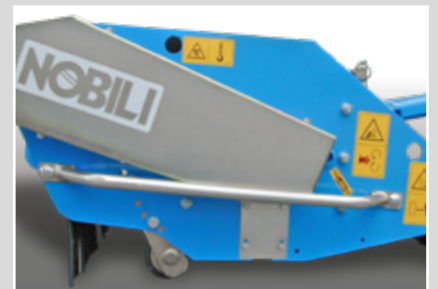
Carter di protezione e rullo regolabile di serie Protective casing and adjustable roller in standard version - Carcasa protectora y rodillo regulable en la versión estándar
