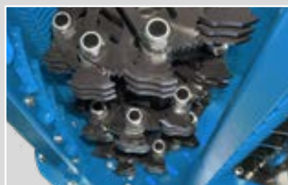
Assenza di griglia calibrata per alte velocità operative
