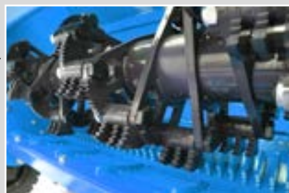
Rotore XP con supporti dentati, coltelli e controcoltelli dentati
