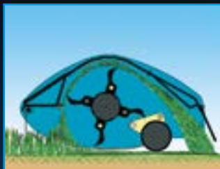
Doppia cofanatura e scarico prodotto trinciato posteriormente al rullo Double hood and mulched product ejection from roller rear side
