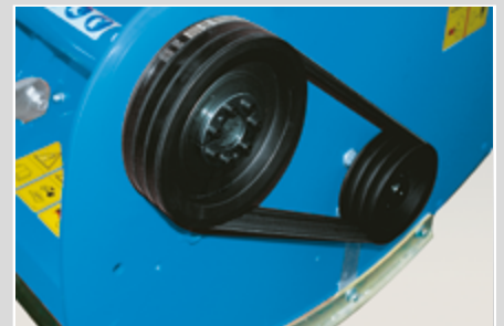
Trasmissione a bagno d'olio e cinghie dentate
