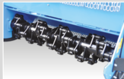
Rotore forestale con mazze a scomparsa Forestry rotor with retractable hammers Rotor forestal con martillos retráctiles
