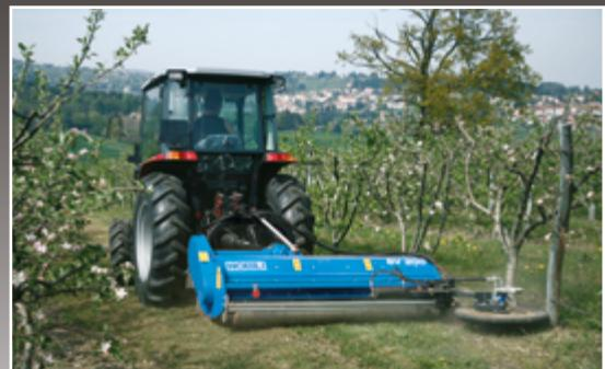
**BV serie 10 e 100 – Disponibile anche con disco idraulico interfilare (optional)**
