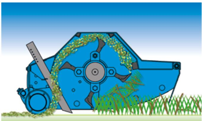
**BV serie 10 – Posizione arretrata del rullo con raschiafango e denti di raccolta / BV serie 10 – Backward position of the roller with mud scraper and collection rakes / BV serie 10 – Posición trasera del rodillo con limpia rodillo y dientes de recogida**
