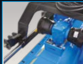
P.d.P. con senso di rotazione sx e dx 540 o 1000 rpm PTO with right (RH) and left (LH) rotation at 540 or 1000 rpm
