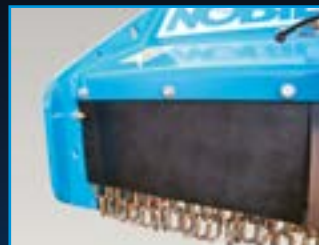
Protezioni con gomme e catene Safety rubber flaps and chains
