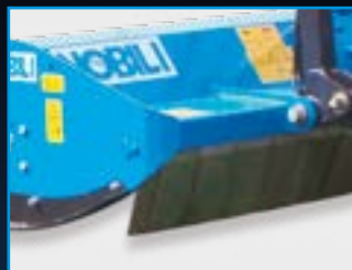
Altezza imbocco maggiorata Enlarged input opening
