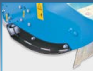
Slitte di appoggio Supporting skids
