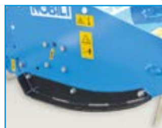
Slitte di appoggio Supporting skids
