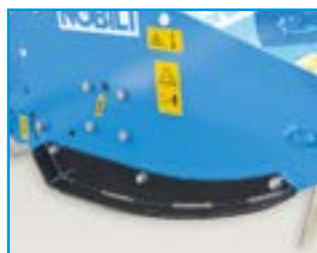
Slitte di appoggio Supporting skids
