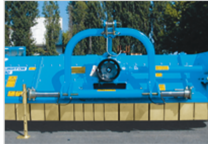
Attacco spostamento laterale idraulico (BK 230 - 280) Hydraulic offset linkage (BK 230 - 280) Enganche desplazamiento lateral hidráulico (BK 230 - 280)
