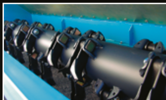
Coltelli spessore 10 mm con perno trattato.
