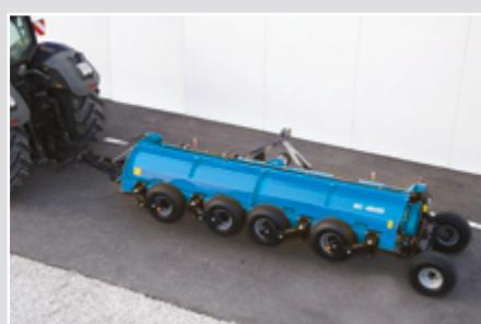
Traino in lungo idraulico (BC 4000-4500)
