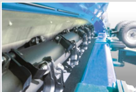
Rotore equilibrato dinamicamente ai massimi regimi della macchina - Dynamically balanced rotor at maximum machine working rates - Rotor equilibrado dinámicamente al máximo régimen de trabajo de la máquina
