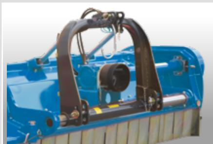
Attacco spostabile idraulico (BC 2800)
