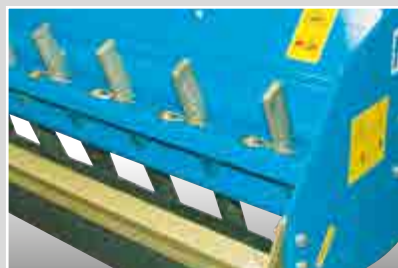
Denti di raccolta Collection rakes Dientes de recogida
