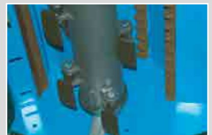
Provvista di 3 controcoltelli: 2 a denti e 1 liscio Equipped with 3 counter-knives: 2 tooth-shaped and 1 straight Equipada de 3 contracuchillas: 2 a dientes y 1 liso
