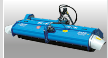
Coclee coassiali con spirali opposte per la pacciamatura da ambo i lati.
