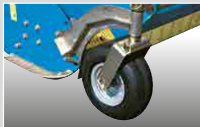
Ruote anteriori pivotanti in gomma per una migliore uniformità di taglio (opzionale). Front pivoting rubber wheels for a better and regular cutting quality (optional). Ruedas frontales giratorias en caucho para una mejor uniformidad de trituración.
