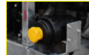
Filtro di aspirazione con valvola per riempimento
