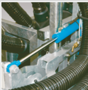
Sollevamento, apertura e chiusura barra idraulica
