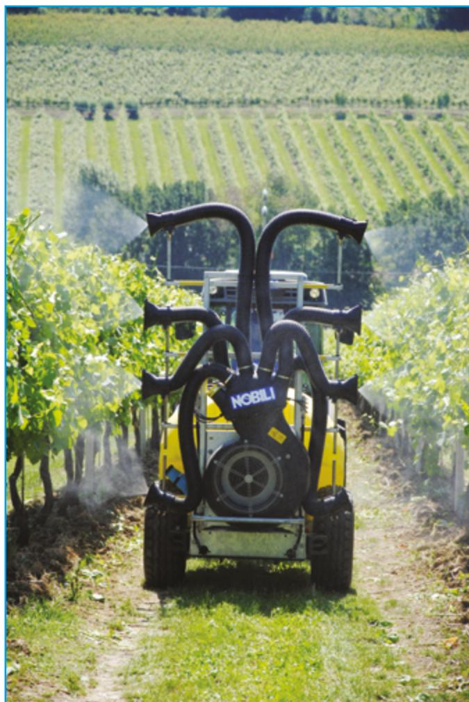
**“Moduli di irrorazione (diffusore + ugello)” costituiti da una bocchetta sagomata e da un polverizzatore “fuori flusso”.**
