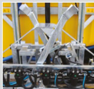
Autolivellante con bloccaggio/sbloccaggio automatico
