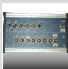
Distributore elettrico-idraulico per movimentazione 3/4 pistoni, con pulsantiera
