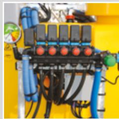
Regolatore di pressione manuale a 5 vie volumetriche con ON/OFF generale elettrico e pulsantiera
