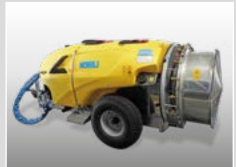
Gruppo ventola Ø 850 con pale a inclinazione variabile Ø 850 fan unit with variable pitch blades
