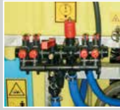
Gruppo comando volumetrico, 4 vie a pressione costante e filtro 4-way volume control unit at constant pressure and filter Grupo de mando volumétrico, 4 vías de presión constante y filtro
