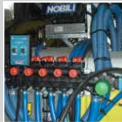
Gruppo comando elettrico 5 vie volumetriche con pulsantiera in cabina 5-way volumetric electric control unit with control box inside the cab Grupo de mando eléctrico de 5 vías volumétricas con panel de control en cabina
