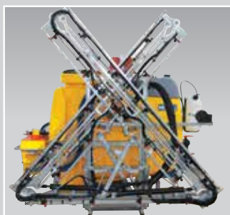
Barra idraulica zincata a caldo PLUS 2 pistoni per movimentazione indipendente dei 4 bracci.
