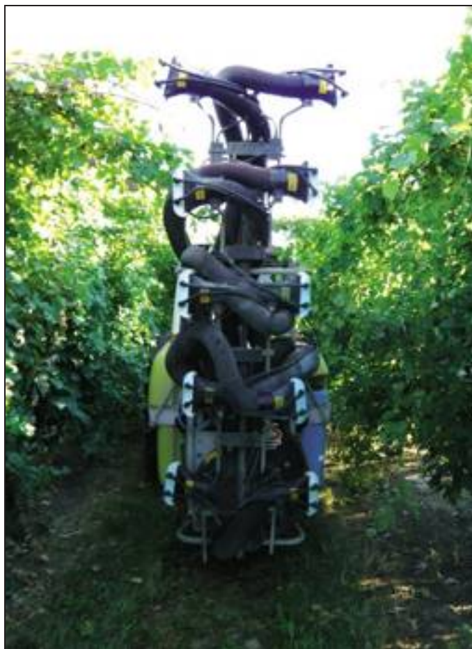
[ 5. Atomizzatore a getti orientabili dotato di dispositivi per l'applicazione della carica elettrostatica (Foto Nobil).
