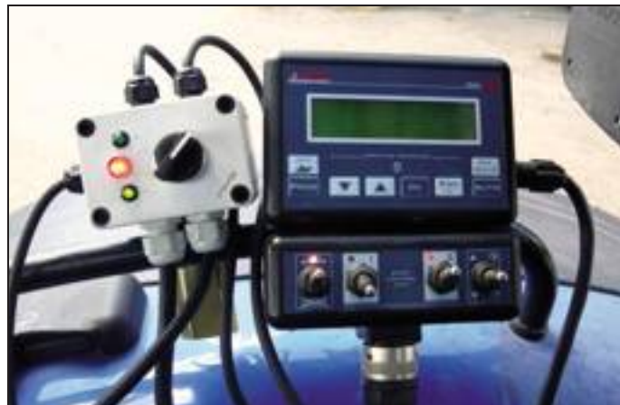
[ 6. Irrorazione elettrostatica. Controllo in continuo per monitorare la funzionalità del sistema (Foto Nobil).
