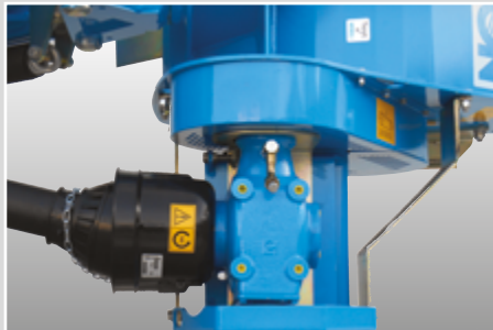
Gruppo rinvio con ruota libera in posizione interna (TBE) o esterna (TBE-S)
