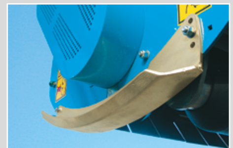
Slitte di consumo arrotondate in hardox per non lasciare solchi sulle aree verdi.
