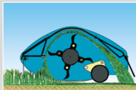
Rotore a 4 file di utensili che garantisce la costante pulizia del rullo di appoggio.
